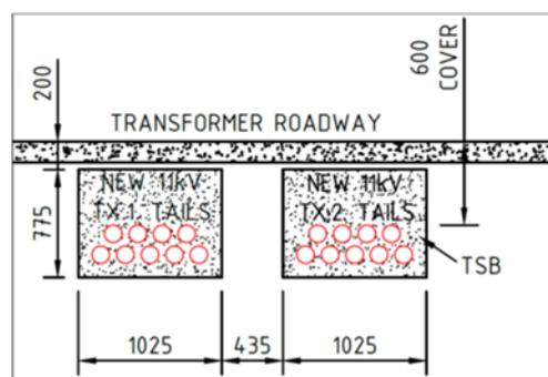
**Figure 3 Plastic conduits for 11kV transformer cables**
